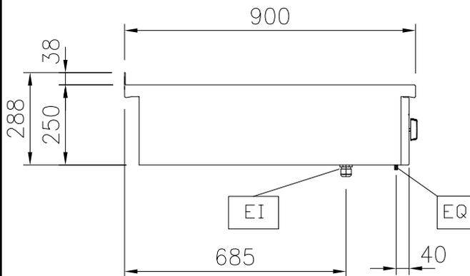
EI = Conexión eléctrica (energía)
